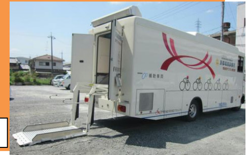
車いす昇降用リフト
